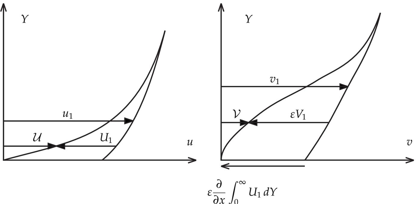
FIGURE 14 – Composantes de la vitesse dans la couche limite.
