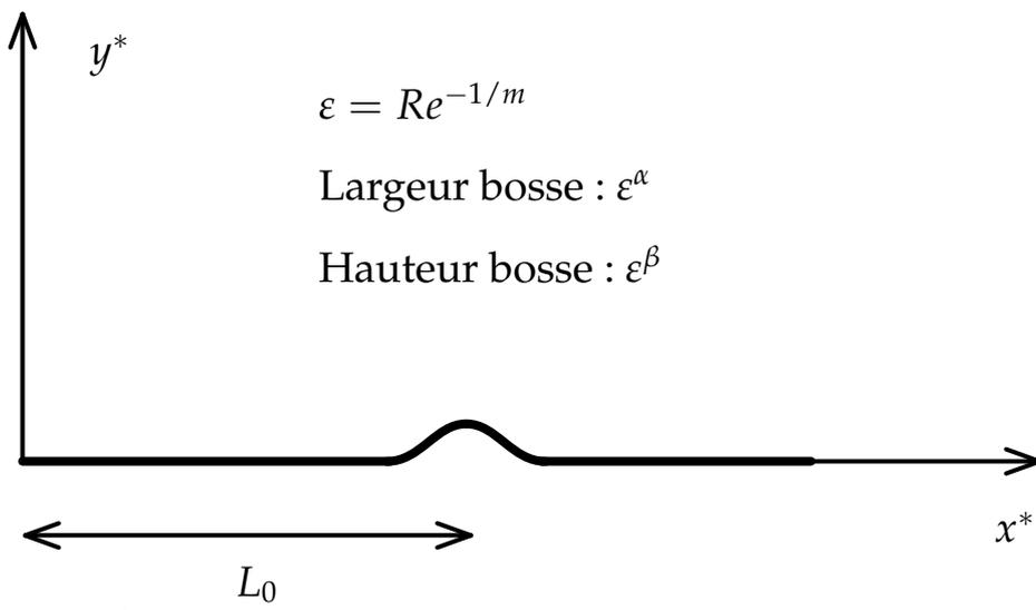
FIGURE 12 – Écoulement sur plaque plane déformée par une bosse.
