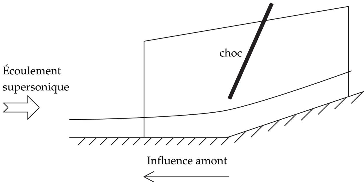
FIGURE 9 – *Influence amont en écoulement supersonique.*
