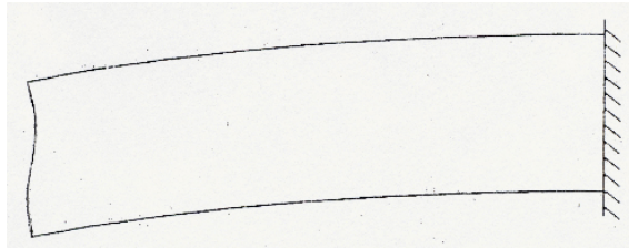
FIGURE 6.8 – Gauchissement des sections lors de la flexion par effort tranchant d'un cylindre de révolution.
